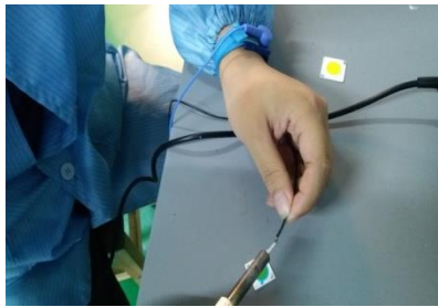
图一、线材焊接前加锡
